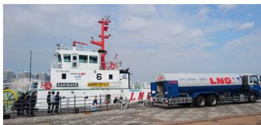
LNG bunkering in Yokohama
