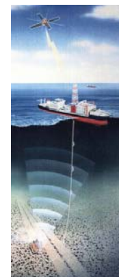
曳航式マンガン団塊採鉱システム (ケネコット、USスチール、インコ、日本)
