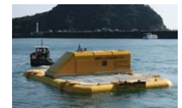
ジャイロダイナミクス社 "ジャイロ式波力発電システム" (神戸大学 神吉教授)
