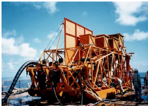
日本が1997年に水深2,200mの海山で実施した海洋実験で使用した曳航式集鉱機
