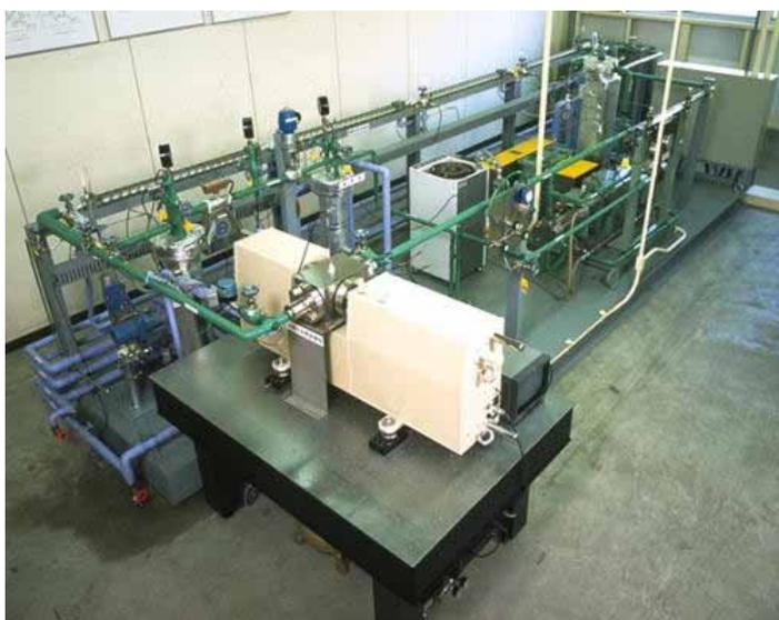
図3 CO<sub>2</sub>ヒートポンプループ試験装置
