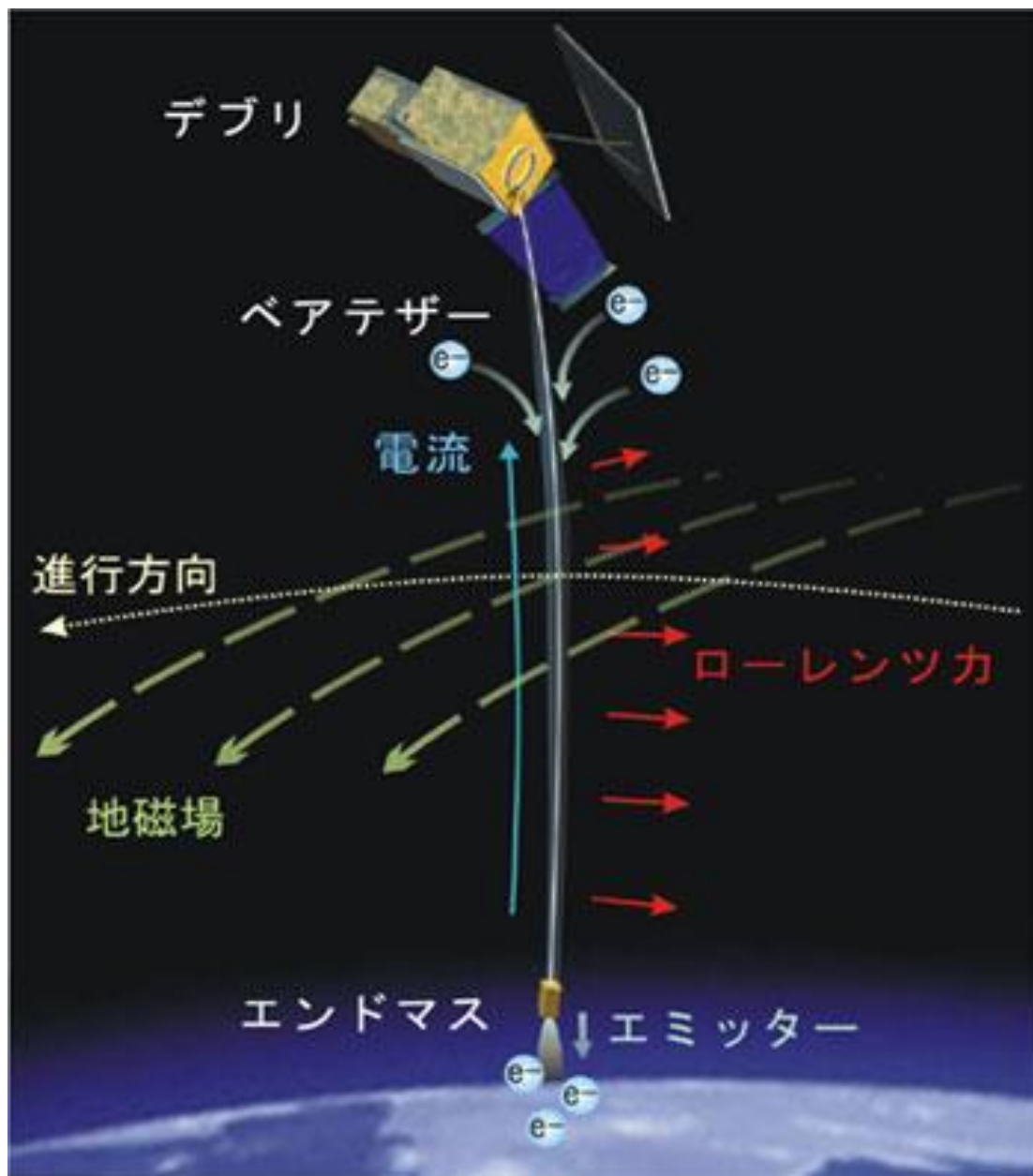
図 2 導電性テザーのデブリ除去原理 11
