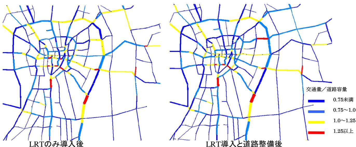
図 2-14 LRT 導入と道路整備を行った場合と行っていない場合の交通流の比較
