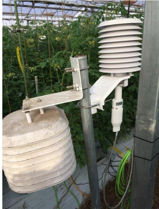
図6 VAISALA 製温湿度計測器
